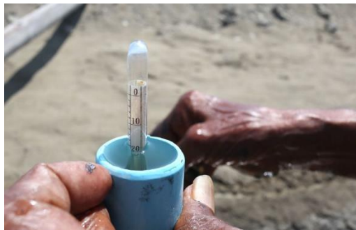
รูปที่ 2 การตรวจวัดความเค็มในของน้ำทะเลในแปลงนาด้วยไฮโดรมิเตอร์
