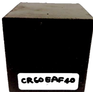
(ค) อิฐจีโอพอลิเมอร์จากกากซีเหล็กและกากซีปูน (Apithanyasai, 2016)
